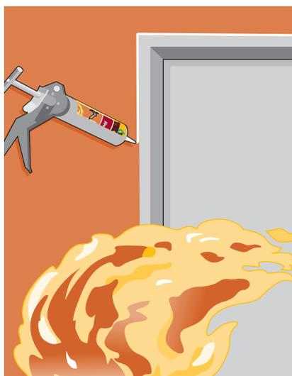
TEKADOM retardante del fuego es una masilla plastoelástica monocomponente de composición acrílica. Se usa para juntas de dilatación en la construcción, en lugares donde se exige el uso de masillas retardantes al fuego. Esta masilla soporta una dilatación del 15%. En caso de incendio, evita la expansión del fuego, humo, gases venenosos y agua.
